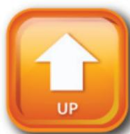
Si se mantiene pulsado el botón UP durante 0,7 segundos, el ajuste aumentará hasta el siguiente múltiplo de 0,10 (por ejemplo, si el ajuste es actualmente 0,36, el ajuste cambiará a 0,40). Cada 0,7 segundos después de mantener pulsado el botón, el ajuste cambiará otros 0,10 (por ejemplo, de 0,40 a 0,50).
